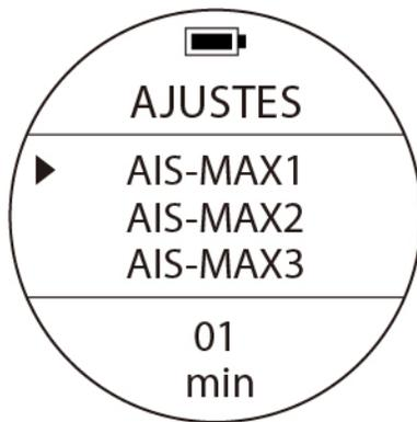
**Apnea / Ajuste a alarmas de Intervalo de Superficie Máximo.**
